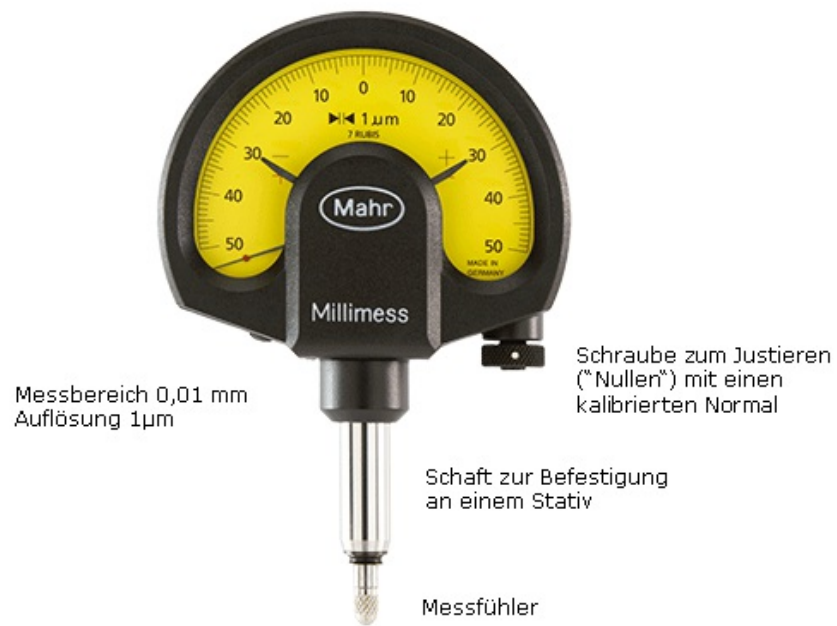
Abb.: Feinzeiger (Messuhr mit kleiner Auflösung)
